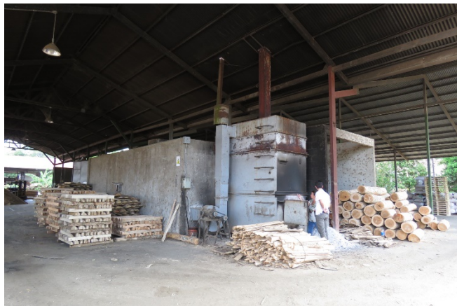
Ilustración 2: Horno de biomasa para secado de madera.
