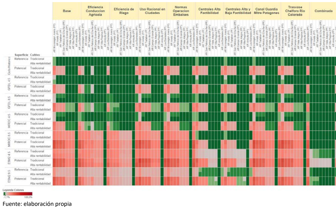
Figura 2.2.1 Profundidad de falla de la cobertura en áreas de riego en la década 2041-2050, Diciembre-Febrero
